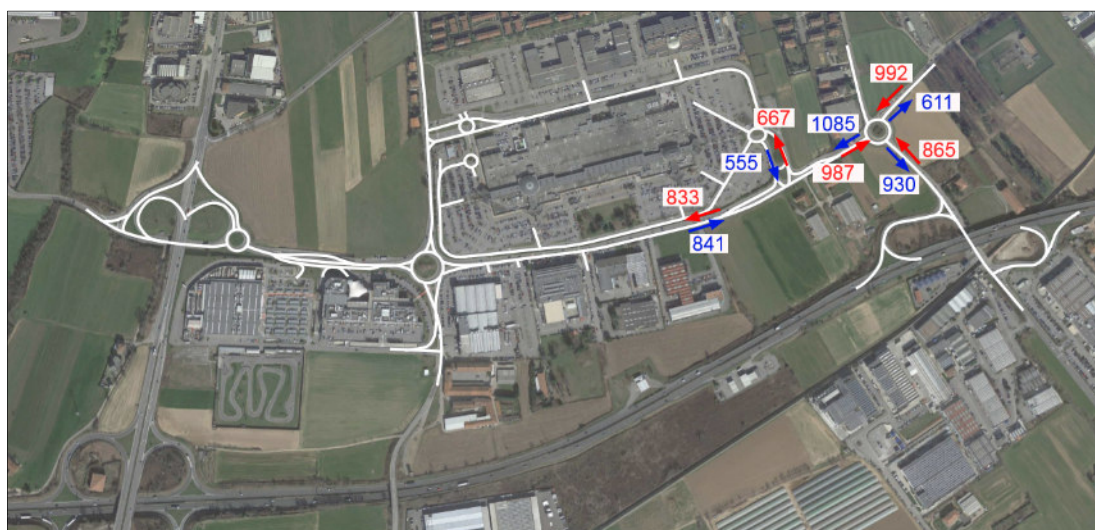
Figura 14 – Flussi dell’ora di punta pomeridiana di un venerdì ferialle di settembre 2015. Fonte: studio di traffico Auchan, 2016
