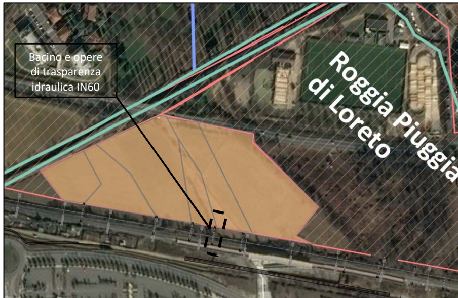
Figura 9.6 - Identificazione bacino degli attraversamenti IN60.
