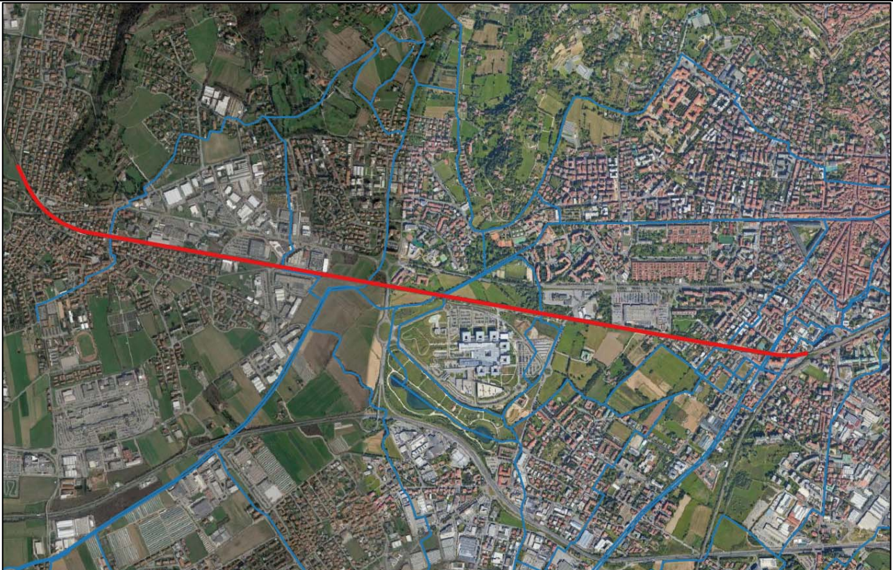
Figura 3.9 - Intersezioni con canali irrigui.
