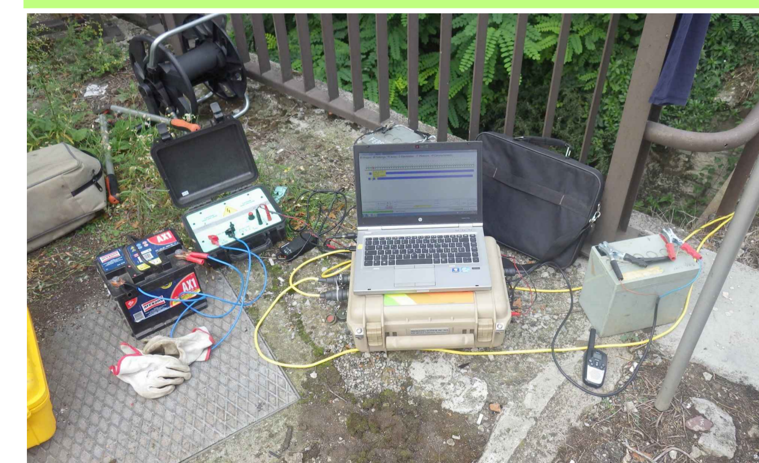
- Strumentazione con georesistivimetro -
