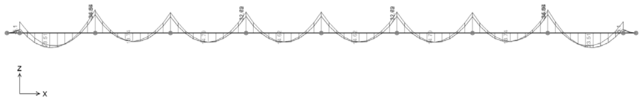
Figura 10.29 - Combinazione SLV – Valori di Momento Flettente M33
