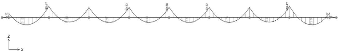
Figura 10.34 - Combinazione SLE frequente – Valori di Momento Flettente M33
