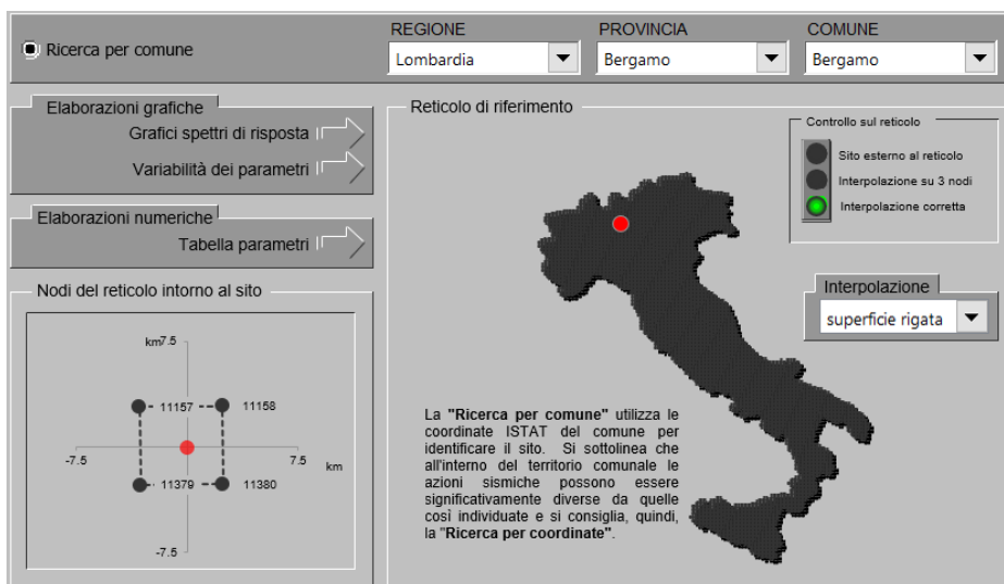
Figura 1: Fase 1, individuazione della pericolosità del sito
