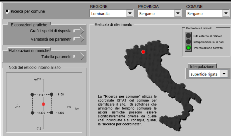
Figura 7: Fase 1, individuazione della pericolosità del sito
