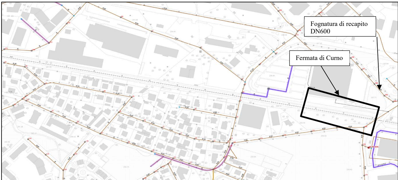
Figura 7.2 - Individuazione recapito impianto di sollevamento di fermata.
