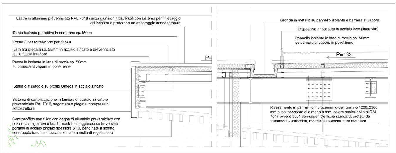
1 DETTAGLIO RIVESTIMENTO E COPERTURA
