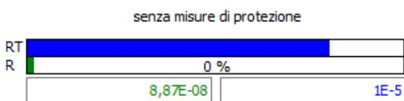
Poiché il rischio calcolato risulta inferiore al rischio tollerabile, la struttura risulta autoprotetta.
