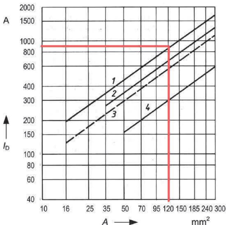
Le linee 1, 2 e 4 si riferiscono ad una temperatura finale di 300 °C, la linea 3 a quella di 150 °C. La Tabella D.2 contiene fattori per la conversione ad altre temperature finali.
