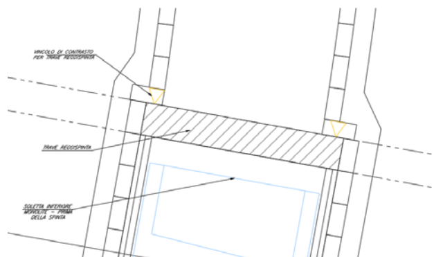
Figura 36 Schema di vincolo della trave reggispinta.
