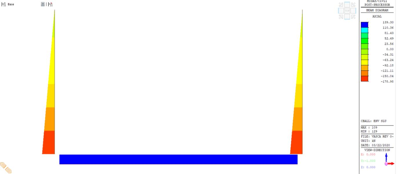
Figura 10: Involuppo N – SLU (modello 1)
