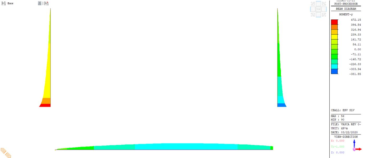
Figura 20: Involuppo M– SLV (modello 1)
