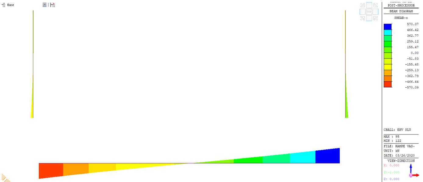
Figura 12: Involuppo T – SLU (modello 2)
