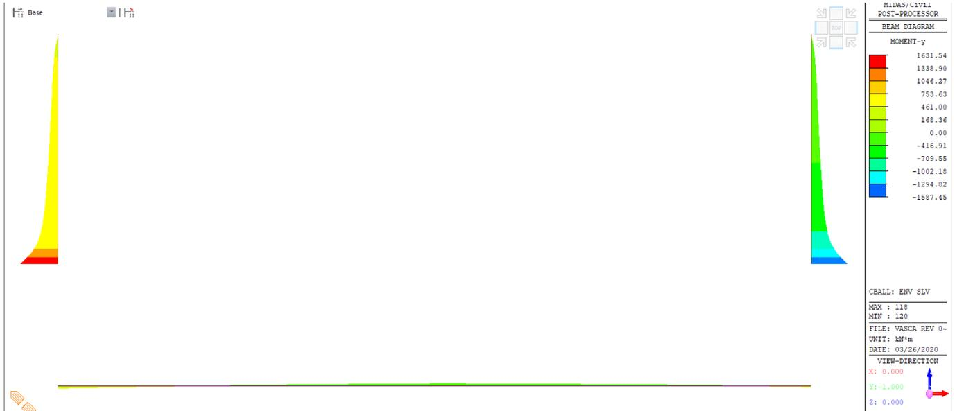
Figura 19: Involuppo M- SLV (modello 1)
