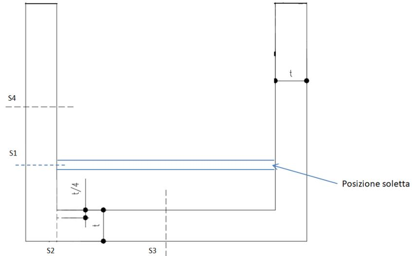
Figura 27: Sezioni di verifica (si fa presente che la sezione di verifica S1 è stata volutamente spostata in corrispondenza della soletta)
