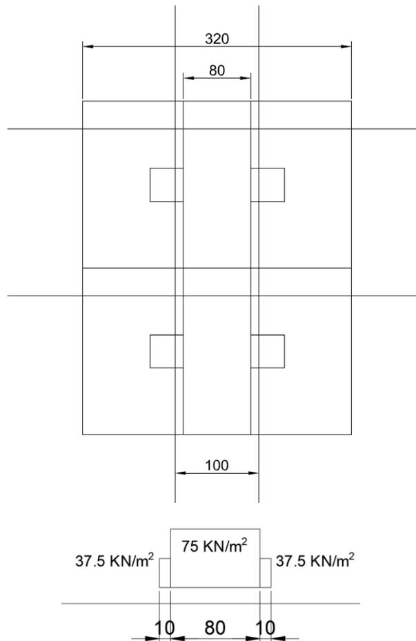
Figura 6-32: Diffusione del carico in senso longitudinale e determinazione del carico agente su soletta in esame.
