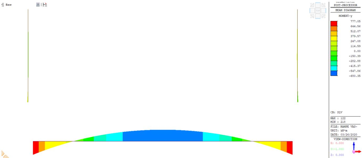
Figura 20: Involuppo M- SLV (modello 2)
