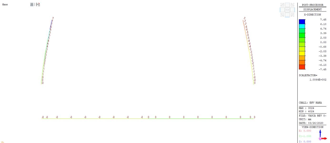
Figura 6-28: Deformazione muro ad “U”-Modello 1
