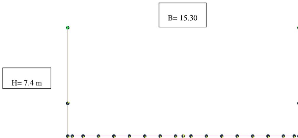
Figura 3: Geometria 1<sup>a</sup> modello strutturale su letto di molle con vincoli allo spostamento orizzontale al centro della soletta di fondazione e uno in corrispondenza della soletta di copertura della vasca posto a 1.70 da interasse soletta
