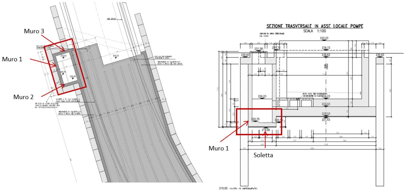
Figura 35: Pianta e Sezione trasversale muro di rifodera "1" e soletta del locale pompe
