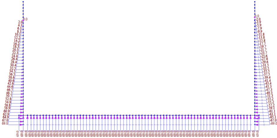
Figura 6 – Spinta idrostatica sui piedritti e sottospinta idraulica
