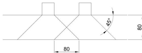
Figura 6-31: Diffusione del carico cooncentrato in senso trasversale per uno spessore a metà soletta di 80 cm.
