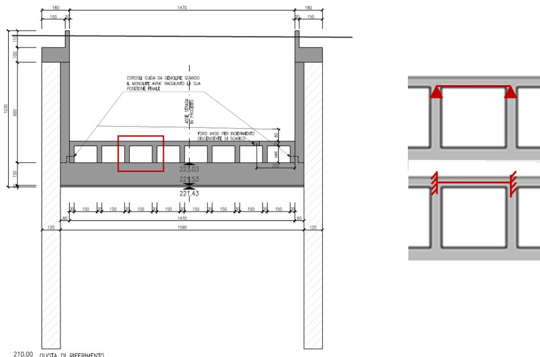
Figura 29: Sezione trasversale muro contenente la vasca, evidenza della soletta calcolata e Schemi di vincolo considerati
