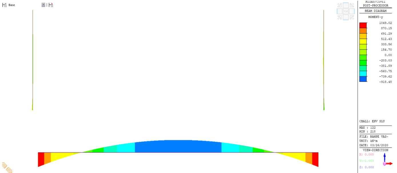
Figura 14: Involuppo M – SLU (modello 2)
