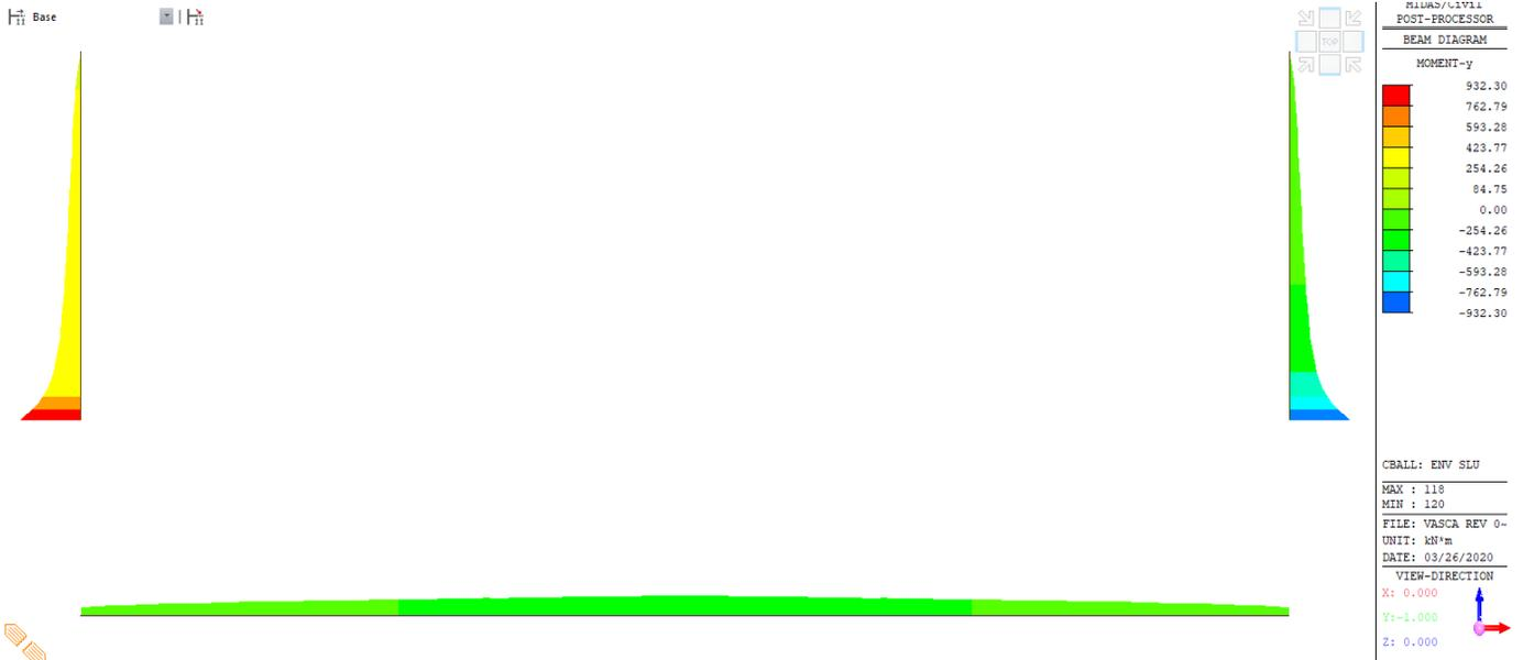
Figura 13: Involuppo M – SLU (modello 1)
