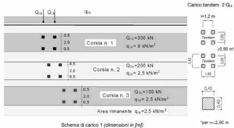
Il carico mobile individuato viene diffuso in riferimento all'asse della soletta (vedasi schema grafico) e disposto sull'impalcato in maniera che massimizzi il carico agente.
