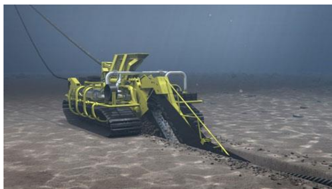
Figura 5.13 – Sistemi di posa e protezione dei cavi
