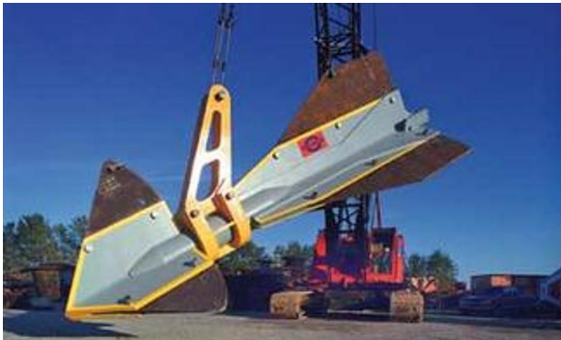
Figura 3.4 – Illustrazione di ancora a gravità con infissione dinamica
