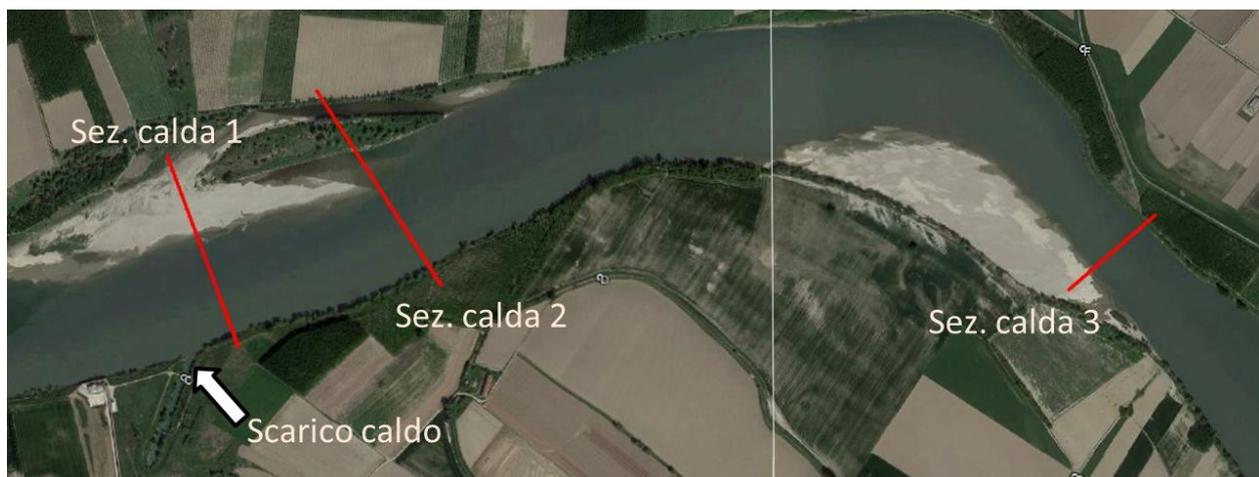
**Figura 7.2.1 - Posizione delle sezioni calde utilizzate per la calibrazione (sezioni calde 1 e 2) e per la verifica degli scenari previsionali (sezioni calde 1, 2 e 3)**
