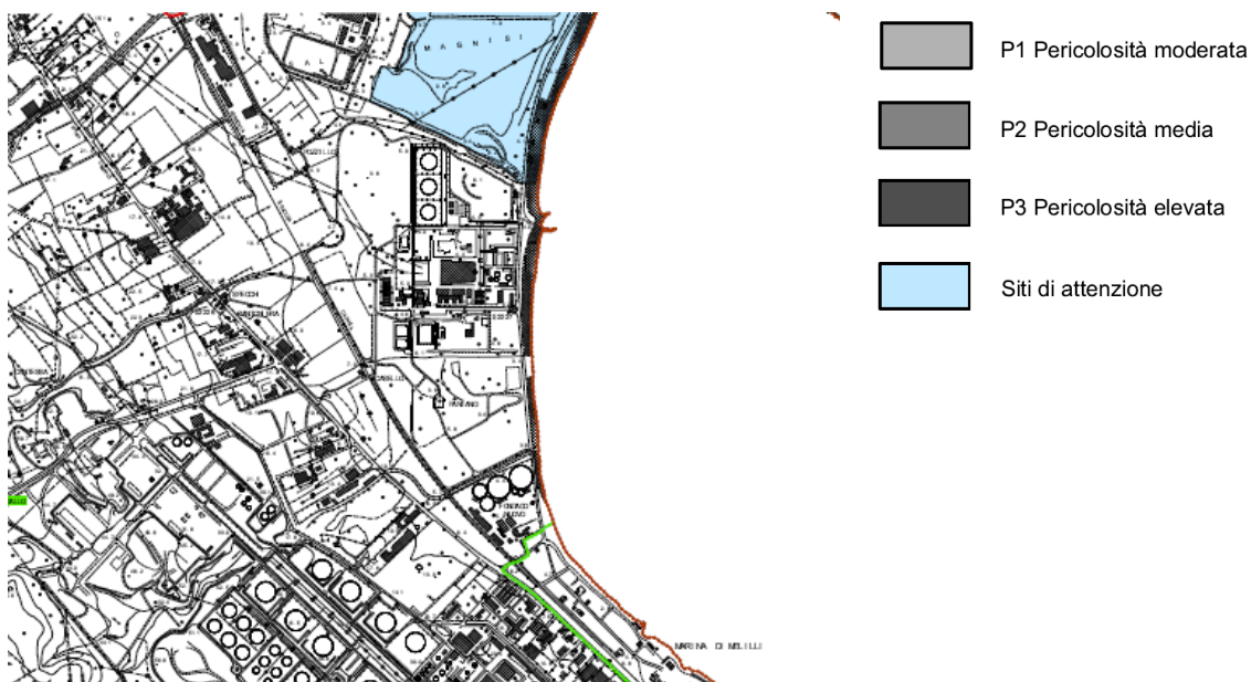
Figura 2.4.8 – Stralcio della carta della pericolosità idraulica per fenomeni di esondazione per l’area di interesse
