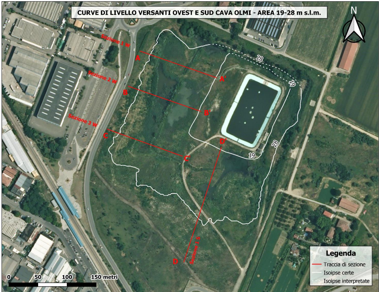
Figura 33 – Area compresa tra le quote 19 e 28 m s.l.m., all'interno della quale è stata individuata la zona di abbancamento sui versanti ovest e sud della cava
