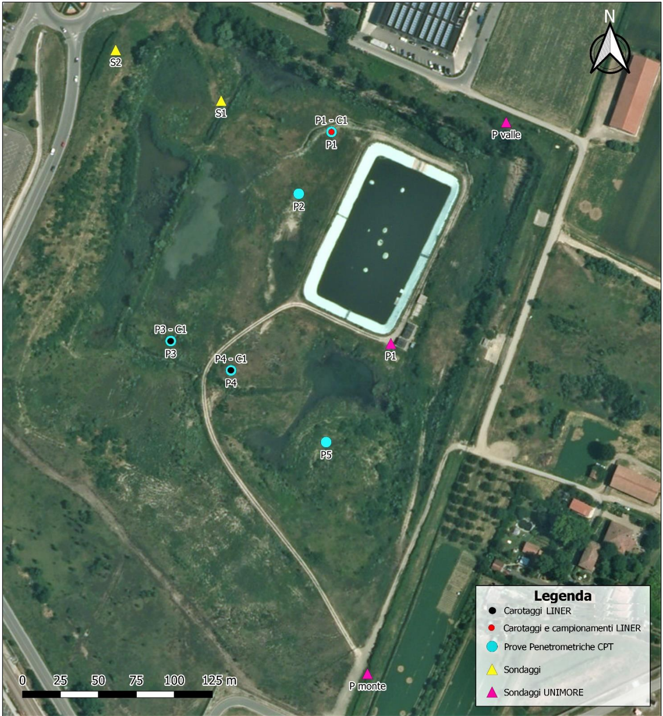
Figura 26 - Ubicazione indagini geognostiche realizzate nel contesto dello Studio di Fattibilità di sistemazione del sito e per il monitoraggio piezometrico condotto da UNIMORE
