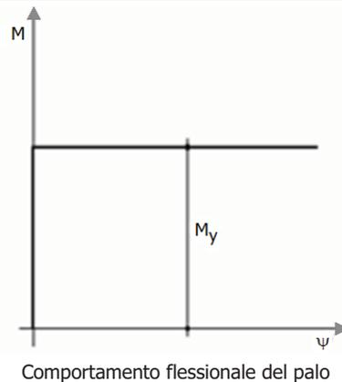
La resistenza limite laterale di un palo è determinata dal minimo valore fra:
