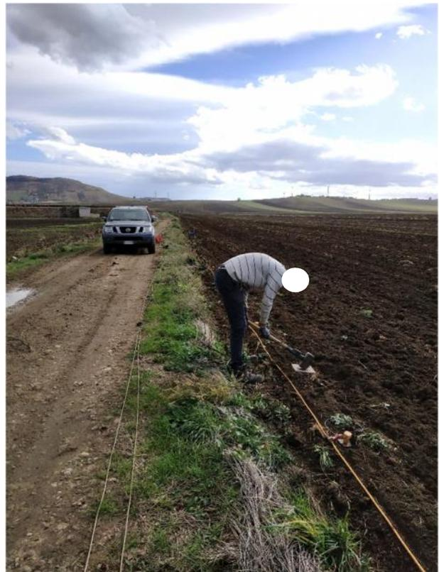
Energizzazione con mazza battente onde di superficie (Masw) e onde longitudinali (Onde P)
