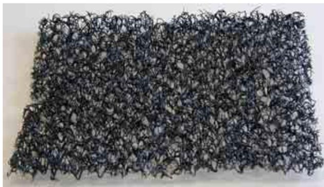
Fig. 18 - Esempio di struttura di geostuoia
