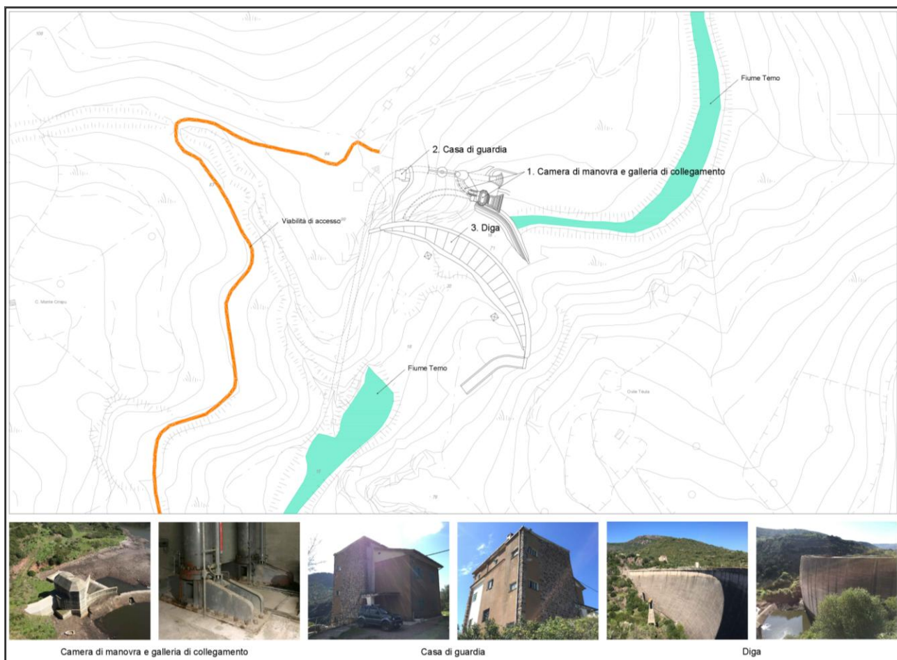
Figura 7 Aree funzionali interessate dagli interventi di manutenzione e riefficientamento
