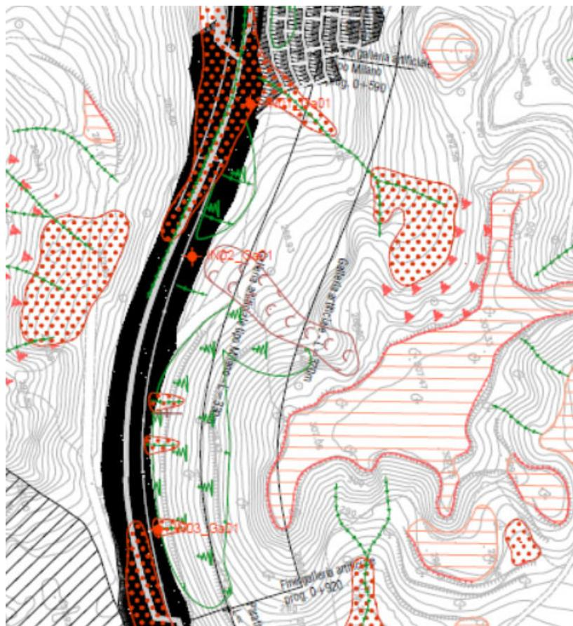
**Figura 4-6 Ubicazione degli inclinometri – Galleria artificiale GA01.**
