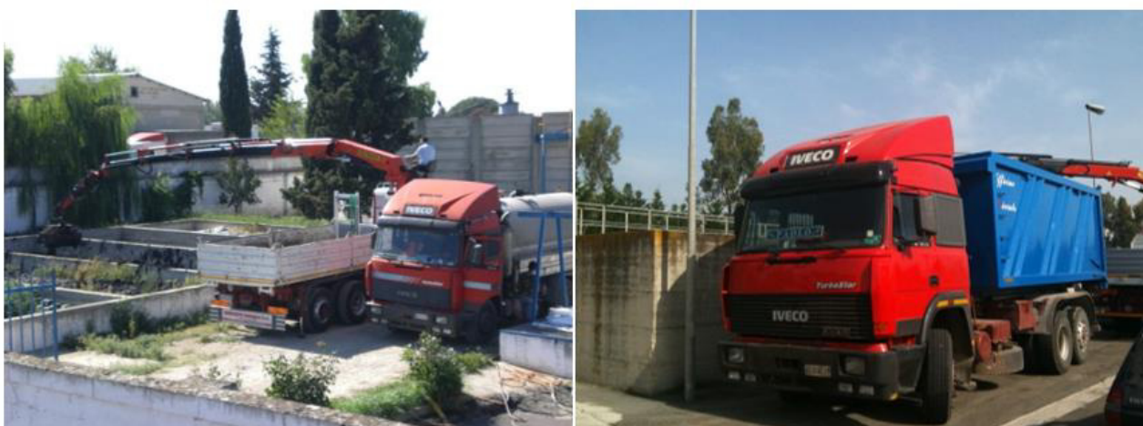
Figura 1 - Automezzi in opera per la rimozione ed il trasporto dei solidi sedimentati
