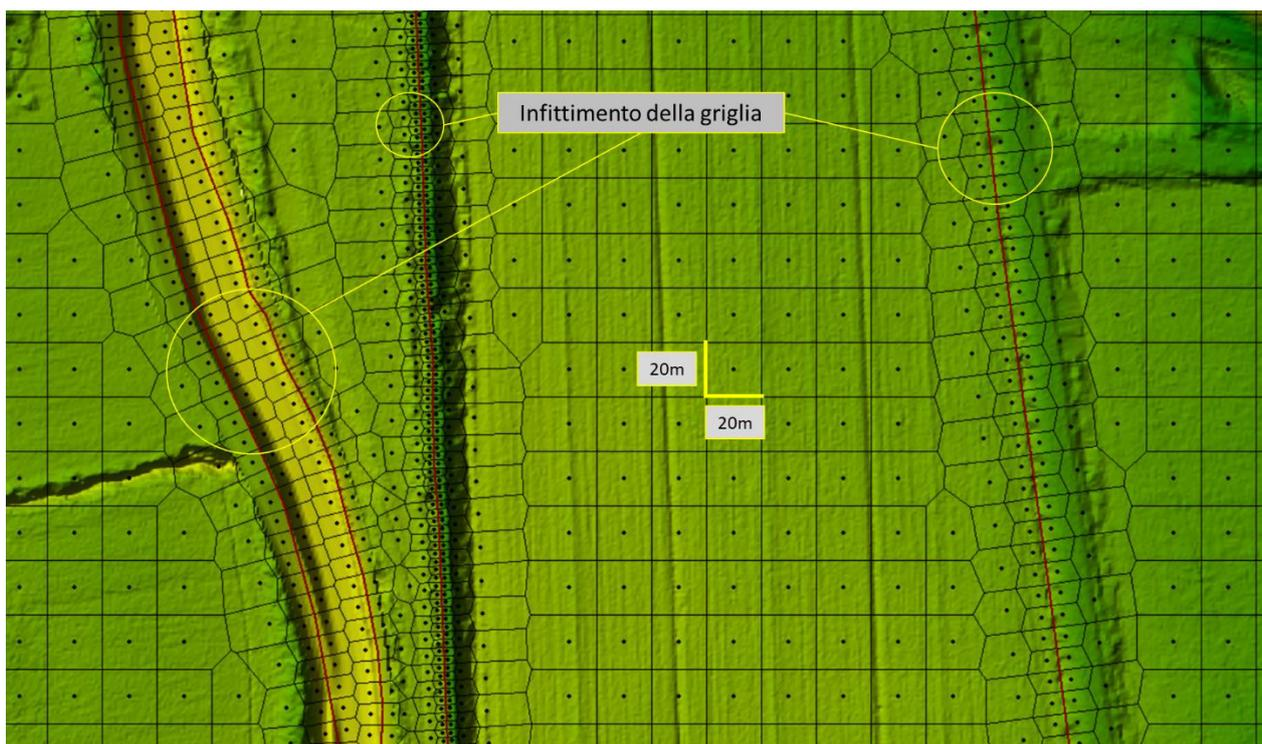
Figura 8 - Griglia di calcolo del modello bidimensionale: lungo tutto l'alveo e in corrispondenza di argini, rilevati, pile e limiti delle risaie, la griglia è stata infittita per tener conto del brusco cambiamento di quota.
