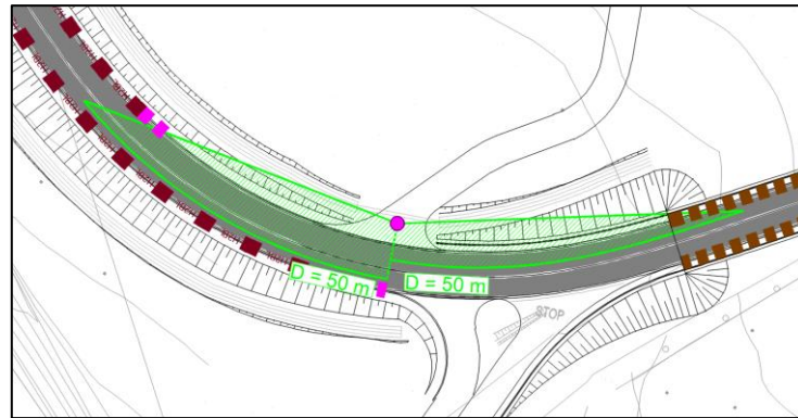
Secondaria 2: accesso alla progr. 0+433.6 – V =30 km/h
