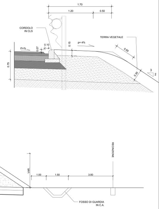
**ASSE PRINCIPALE IN RETTIFOLO - SEZIONE TIPO IN SCAVO CON PARATIA- 1:50**
