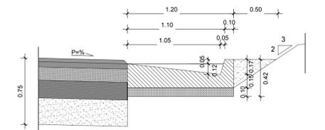
RAMPA MONODIREZIONALE - SEZIONE TIPO IN SCAVO - 1:50
