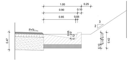
STRADA CAMPESTRE ASFALTATA - SEZIONE TIPO IN SCAVO - 1:50
