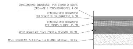
ROTATORIA - SEZIONE TIPO IN RILEVATO - 1:50
