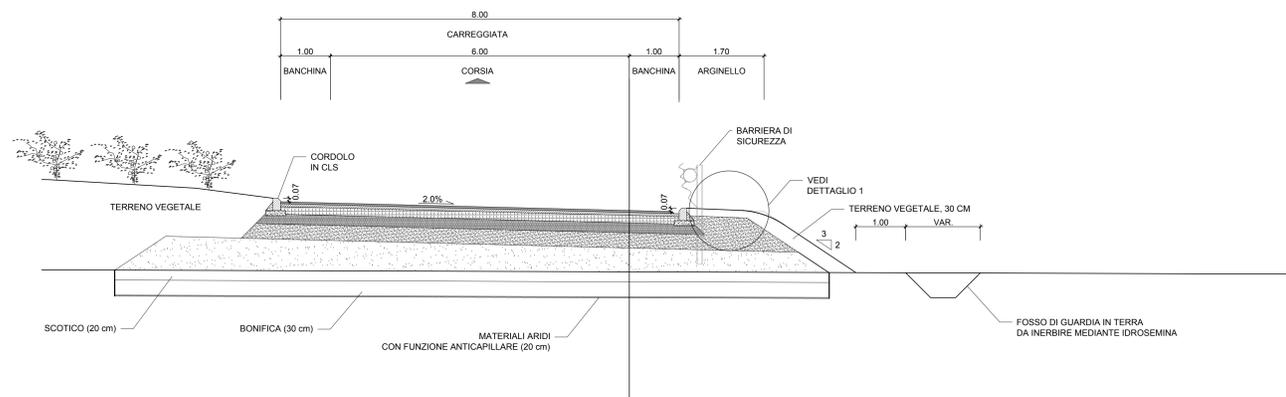
DETTAGLIO 1 - MARGINE IN RILEVATO - 1:20
