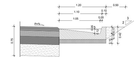
ROTATORIA - SEZIONE TIPO IN SCAVO - 1:50
