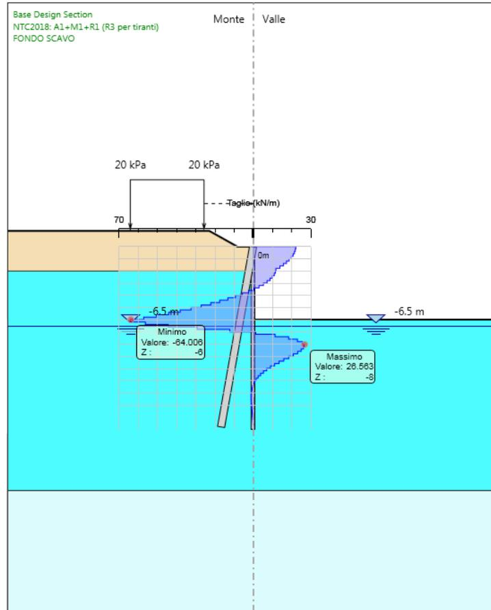
Figura 3: Modelli SLU: Involuppo Diagramma del Taglio
