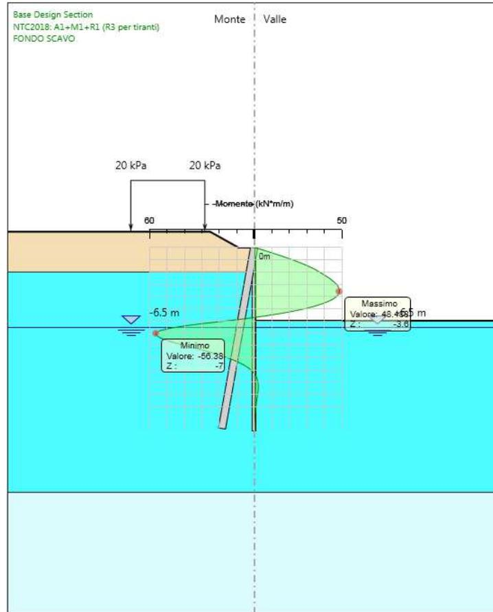
Figura 2: Modelli SLU: Involuppo Diagramma del Momento
