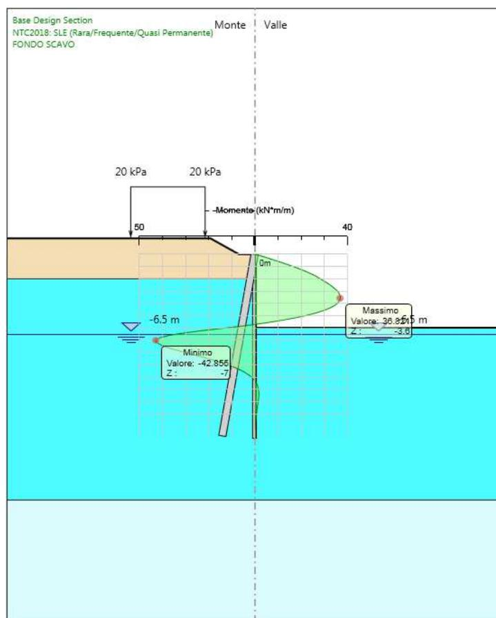
Figura 1: Modello SLE: Inviluppo Diagramma del Momento
