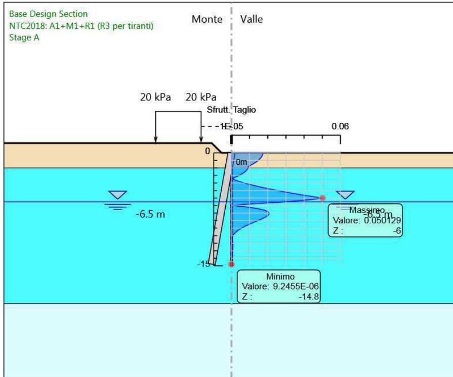
Figura 7: Modello SLU: Verifica a taglio
