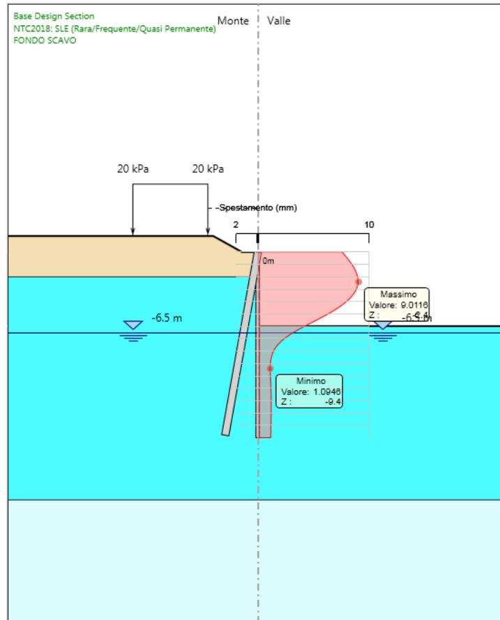
Figura 4: Modello SLE: Inviluppo degli spostamenti
