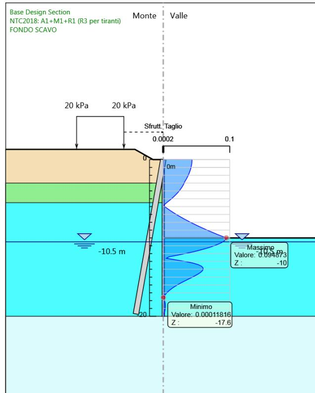
Figura 7: Modello SLU: Verifica a taglio
