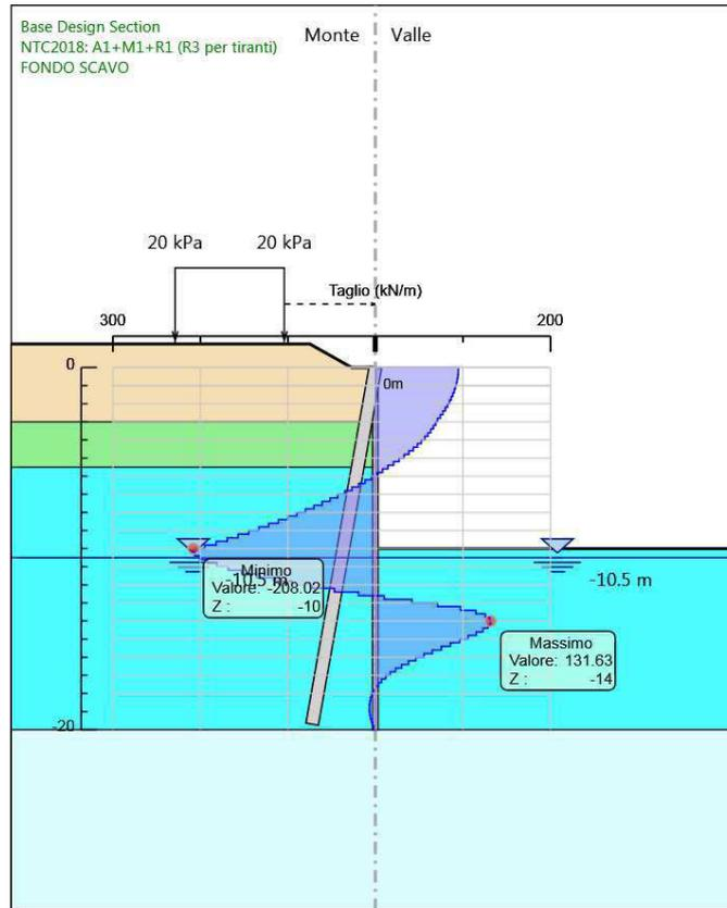
Figura 3: Modelli SLU: Inviluppo Diagramma del Taglio
