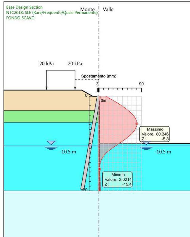
Figura 4: Modello SLE: Involuppo degli spostamenti
