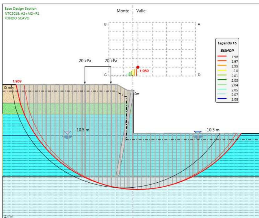
Figura 5: Risultati dell’analisi di stabilità globale
