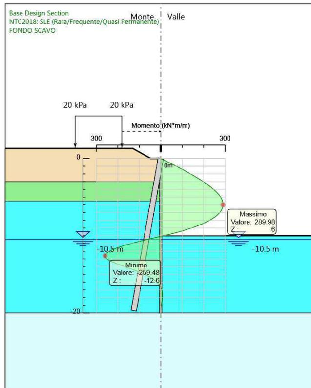
Figura 1: Modello SLE: Involuppo Diagramma del Momento
