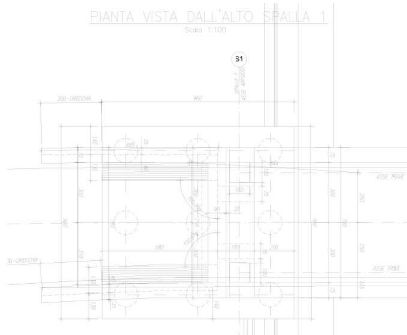
Figura 5: Pianta impalcato spalla S1
