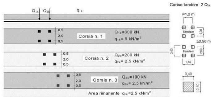
Figura 1: Schemi di carico - carichi  $Q_{ik}$  e  $q_{ik}$ .
