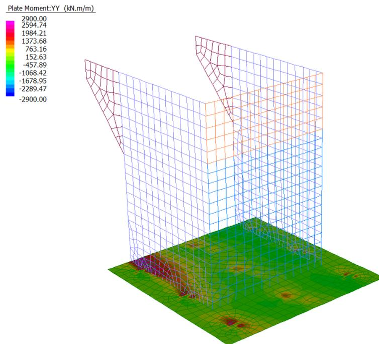
Figura 32: Momento Flettente trasversale - Involuppo SLU/SLV
