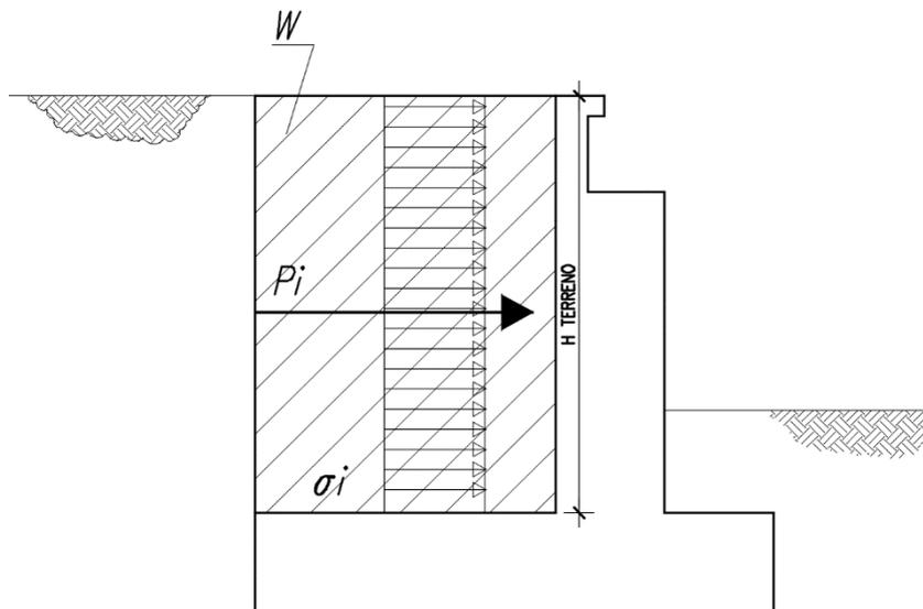
Figura 11: Schema per il calcolo degli effetti inerziali
