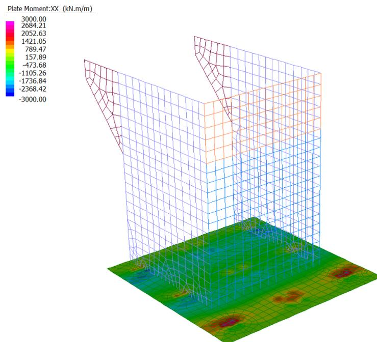
Figura 36: Momento Flettente longitudinale - Involuppo SLU/SLV
