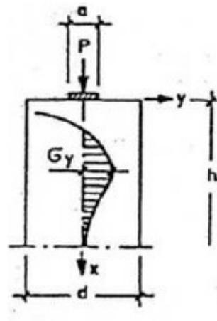
Figura 38: Curva delle tensioni di trazione trasversale  $\sigma_y$
