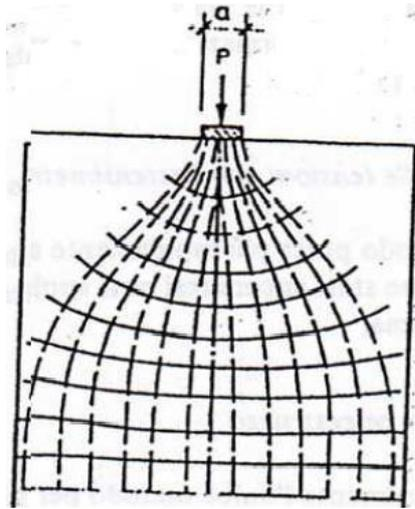
Figura 37: Andamento delle isostatiche di compressione
