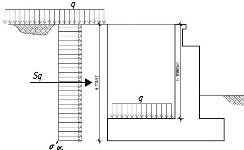
Figura 7: Schema per il calcolo degli effetti della spinta dovuta al sovraccarico accidentale
