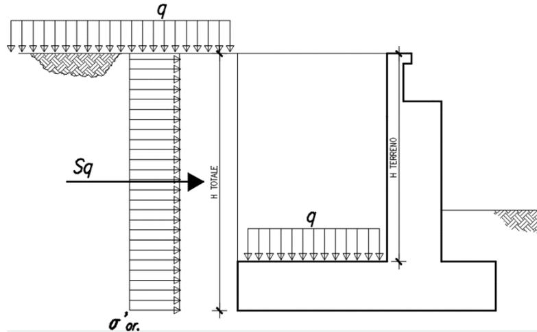
Figura 6: Schema per il calcolo degli effetti della spinta dovuta al sovraccarico permanente
