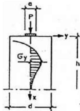
Figura 38: Curva delle tensioni di trazione trasversale  $\sigma_y$
