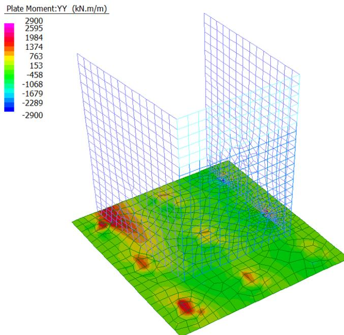
Figura 32: Momento Flettente trasversale - Involuppo SLU/SLV
