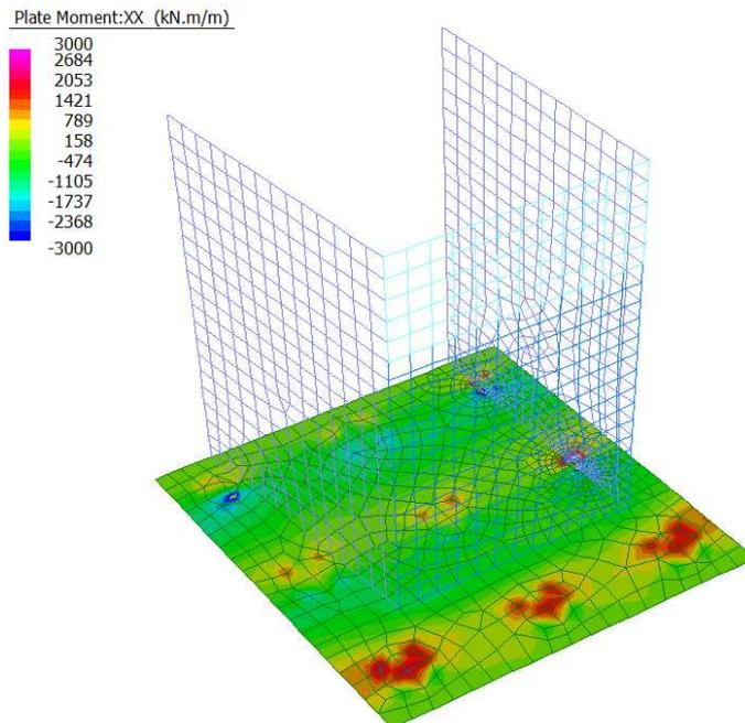
Figura 36: Momento Flettente longitudinale - Involuppo SLU/SLV
