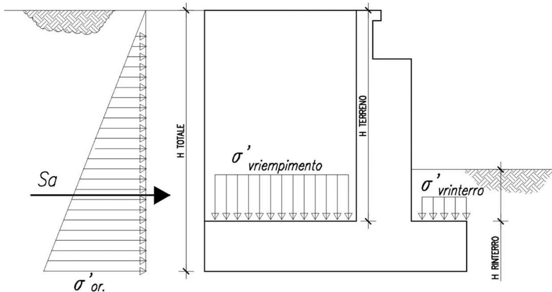
Figura 5: Schema per il calcolo degli effetti della spinta statica del terreno
