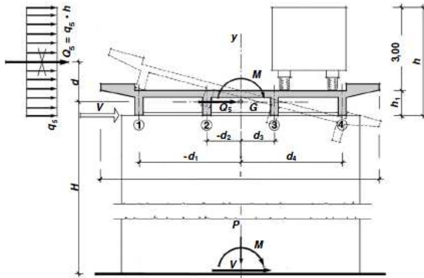
Figura 3: Direzione dell'azione del vento sul ponte
