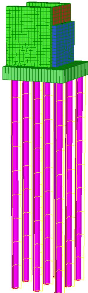
Figura 12: Modellazione tridimensionale agli Elementi Finiti
