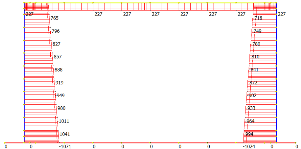
Figura 25 Involucro SLE: sforzo normale
