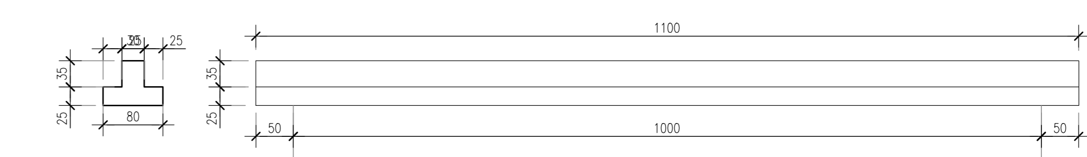
CARPENTERIA TRAVI PREFABBRICATE
