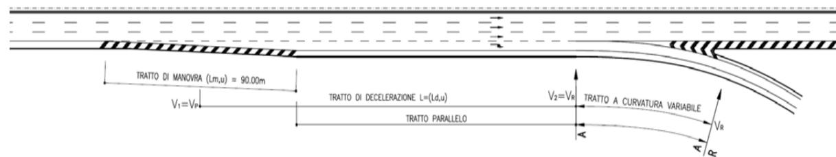
Figura 2-5 - Schema planimetrico corsia di uscita (diversione) - tipologia parallela
