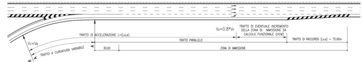
Figura 2-6 – Schema planimetrico corsia di immissione
