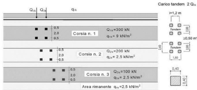
Figura 5: Schemi di carico - carichi  $Q_{ik}$  e  $q_{ik}$
