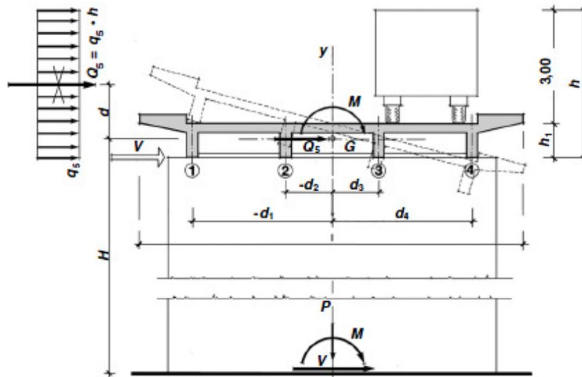
Figura 12: Direzione dell'azione del vento sul ponte
