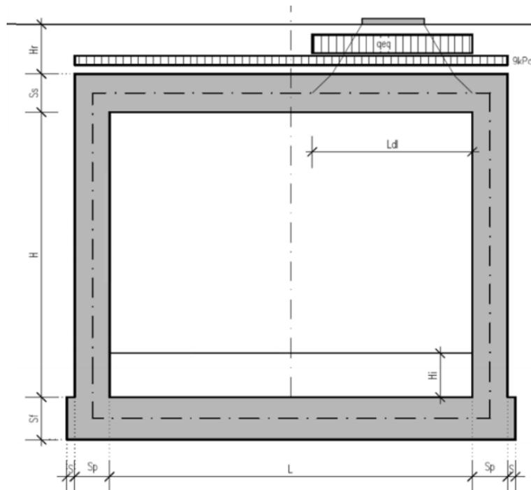
Figura 8: Condizioni di carico che massimizza il taglio della soletta a filo piedritto
