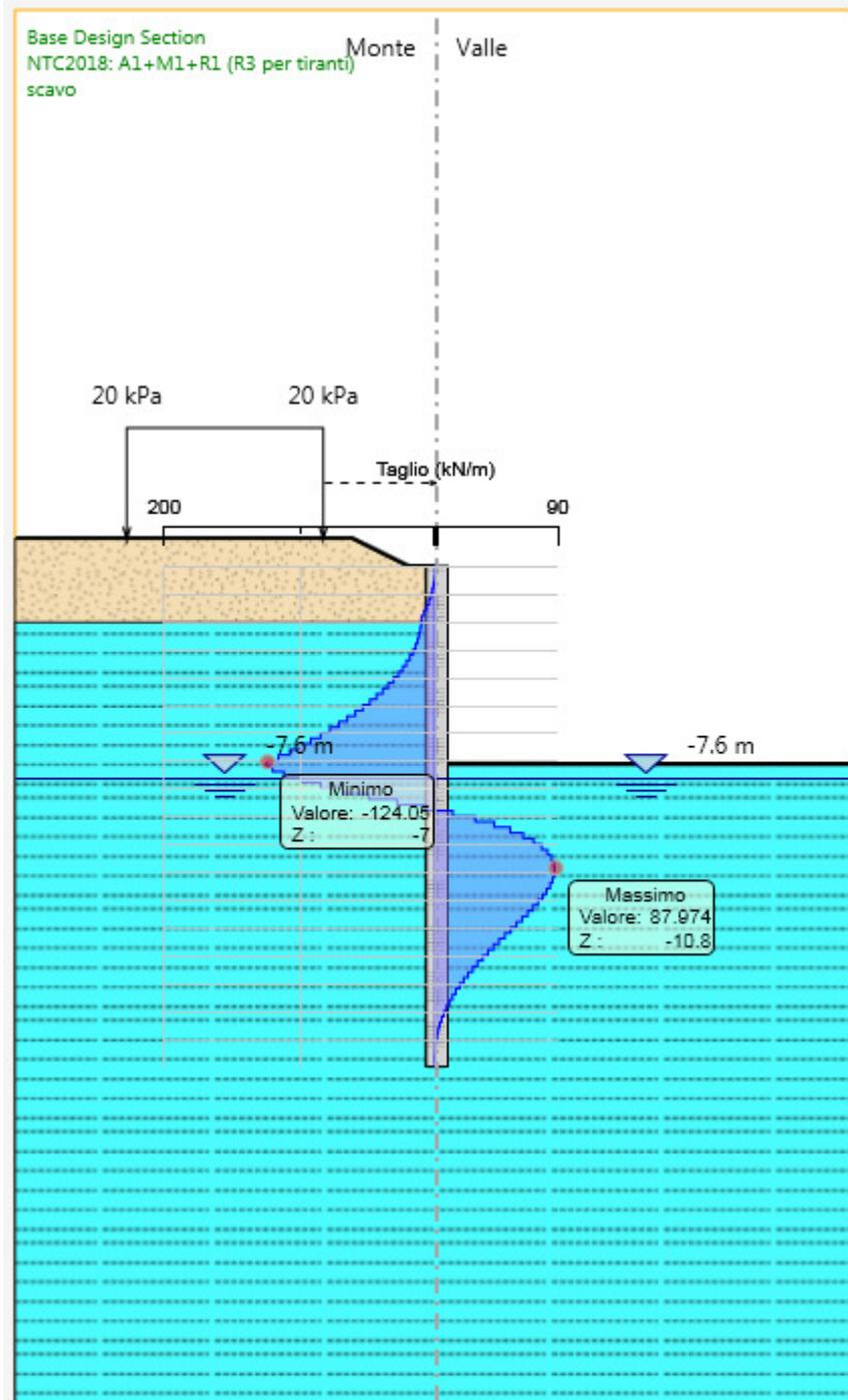
Figura 3: Modelli SLU: Involuppo Diagramma del Taglio
