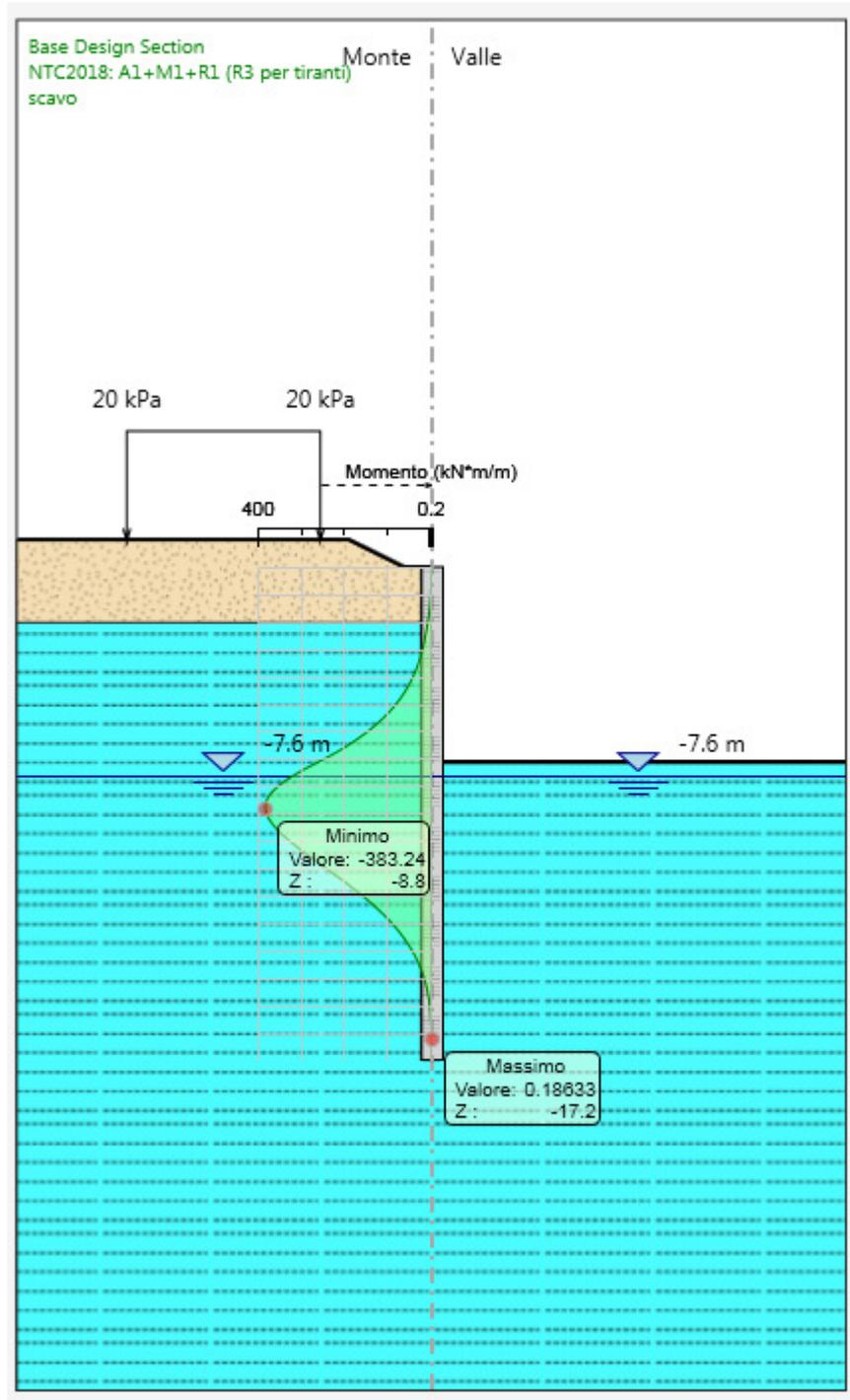
Figura 2: Modelli SLU: Involuppo Diagramma del Momento
