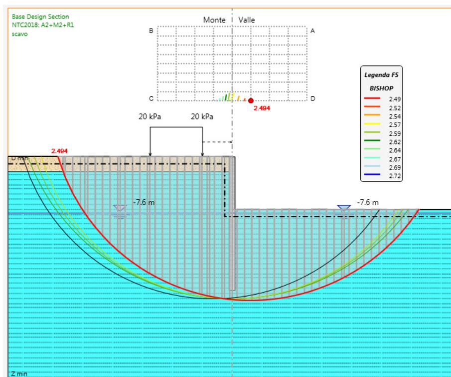
Figura 5: Risultati dell’analisi di stabilità globale
