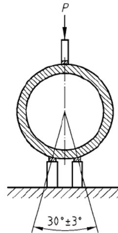
Nelle condizioni reali il tubo si verrà a trovare in situazioni abbastanza differenti da quelle ipotizzate nella prova. In particolare nel caso di tubi interrati i carichi sulla volta saranno di tipo distribuito e lateralmente il terreno presente eserciterà una azione di confinamento.
