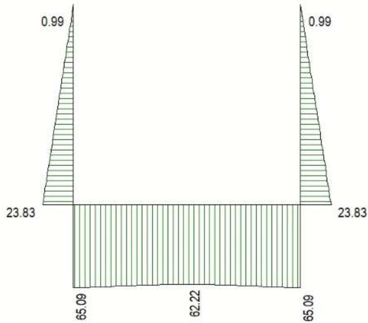
Figura 5 Involuppo SLU/Sisma: sforzo normale
