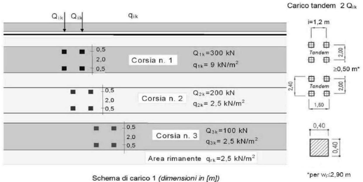
Tali carichi vengono posizionati ortogonalmente all’asse longitudinale dell’opera, ripartendoli sia in direzione longitudinale che trasversale, assumendo i seguenti angoli di diffusione:
