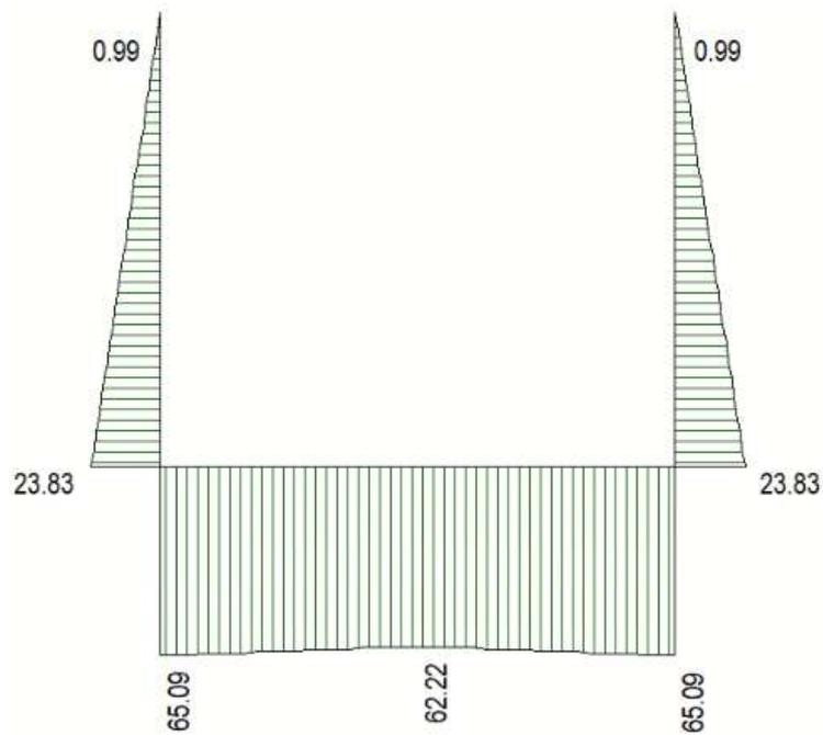
Figura 5 Involuppo SLU/Sisma: sforzo normale
