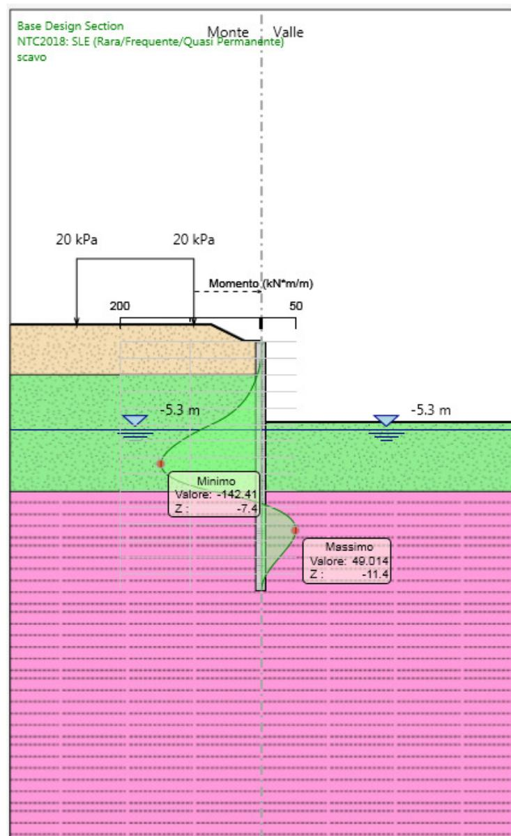
Figura 1: Modello SLE: Involuppo Diagramma del Momento
