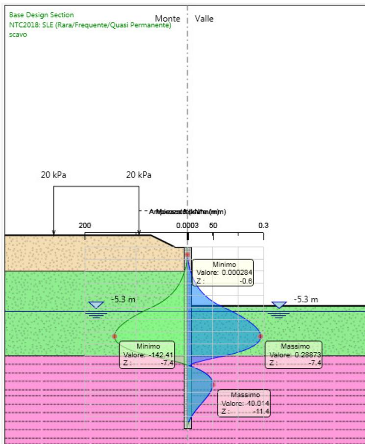
Figura 6: Modello SLE: verifica a fessurazione
