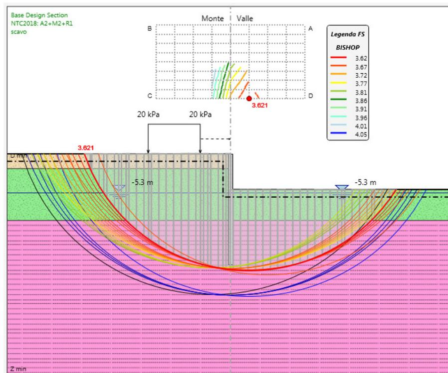
Figura 5: Risultati dell’analisi di stabilità globale
