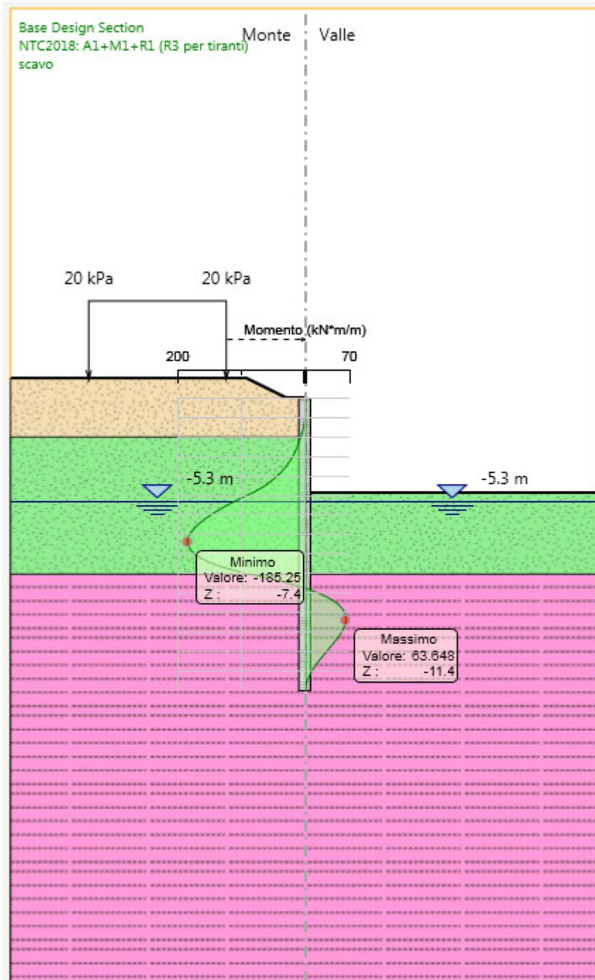
Figura 2: Modelli SLU: Inviluppo Diagramma del Momento
