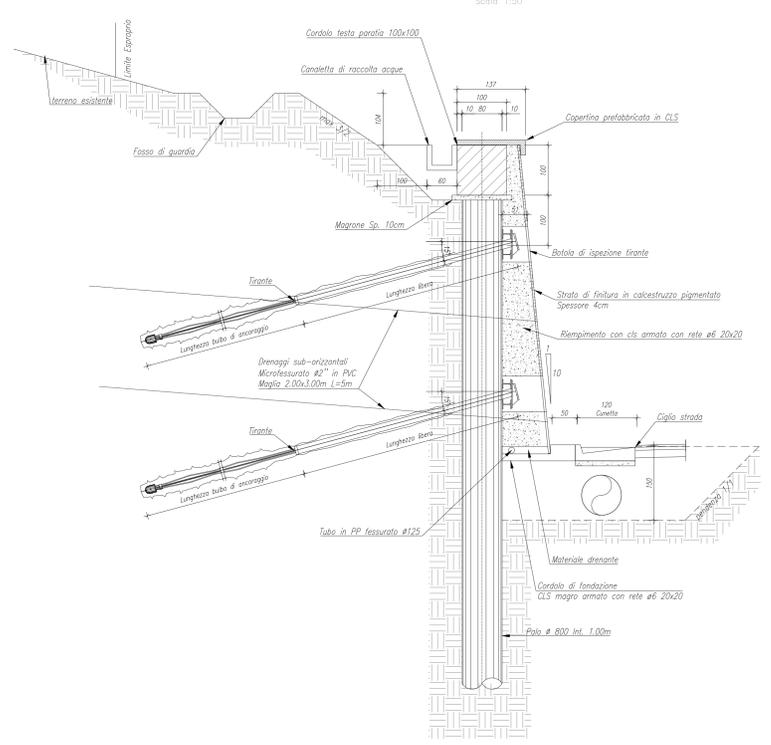
**SEZIONE TIPO MURO DI CONTRORIPA**
