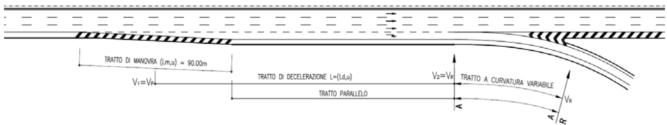
Figura 11 - schema planimetrico corsia di uscita (diversione) - tipologia parallela
