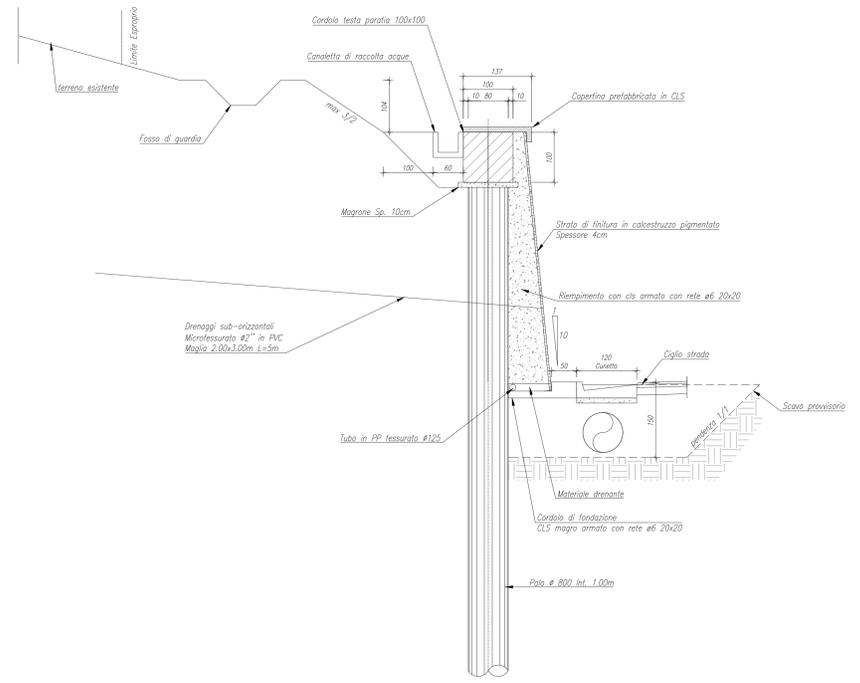
SEZIONE TIPO MURO DI CONTRORIPA
