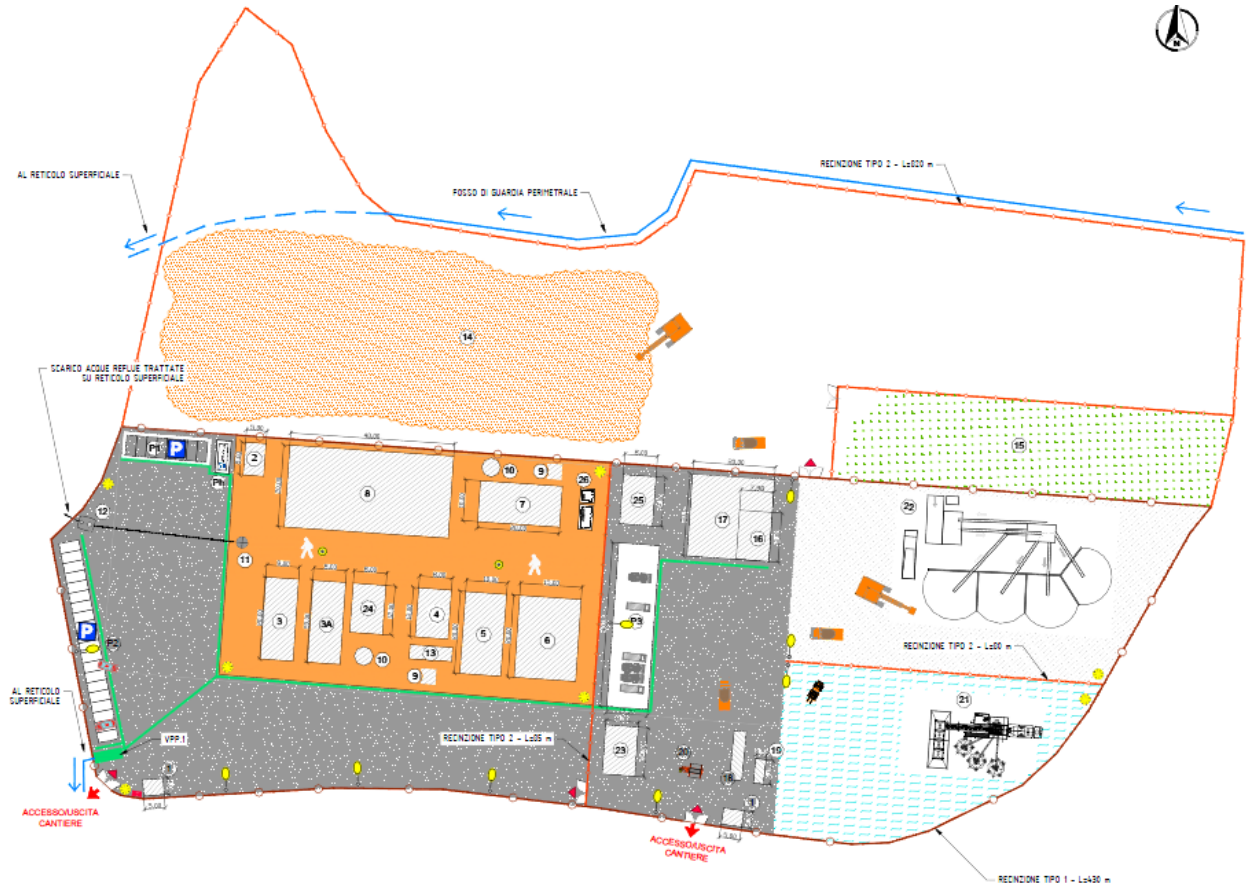
Figura 4.1 – Planimetrica cantiere base con rete di drenaggio.
