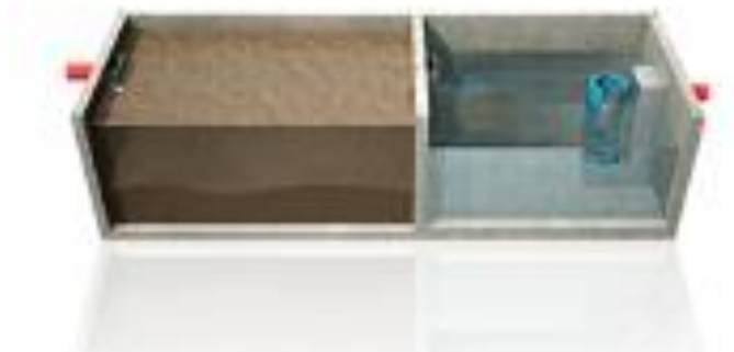
Figura 4.3 - Schema vasca di prima pioggia in continuo.
