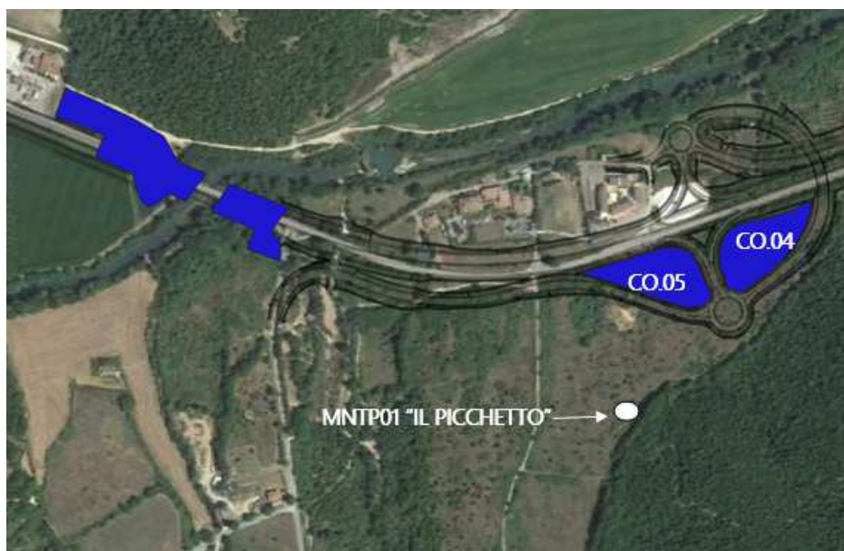
Figura 8 Pozzo idropotabile “il Picchetto” e aree di cantiere che possono interferire con esso.
