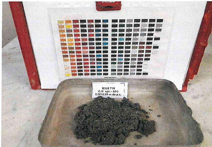
Prove eseguite: Apertura e descrizione del campione (ASTM D2488); contenuto d'acqua (ASTM D3080); massa volumica apparente dei grani (UNI EN 1097-6); analisi granulometrica mediante setacciatura e per decantazione (ASTM D422); limiti di consistenza liquida e plastica (o di Atterberg) (UNI 10014).
